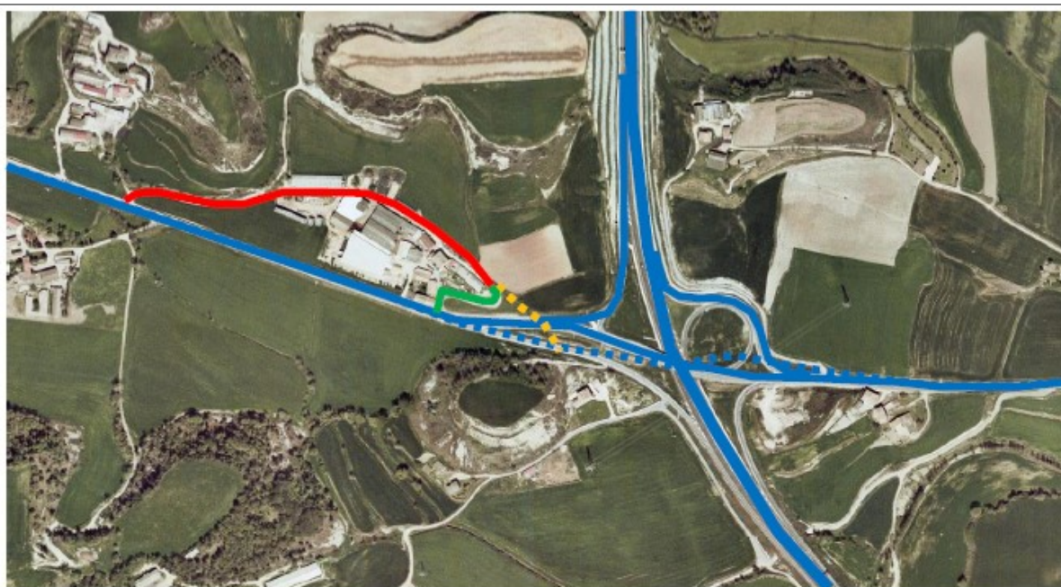
Figura 5. Foto aèria de l'any 2001, indicant les infraestructures viàries actuals (blau), el traçat anterior de l'antiga carretera de Prats (blau discontinu), el camí de Can Capdell (vermell), amb el tram de camí que ha quedat tallat (groc discontinu) i el nou accés pel costat de Can Capdell de baix (verd) (Font: Pròpia)
