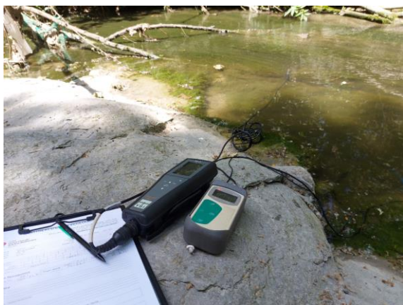
Figura 5. Sondes de conductivitat elèctrica, pH, temperatura i oxigen dissolt, per a la presa de dades in situ a cada punt de mostreig.
