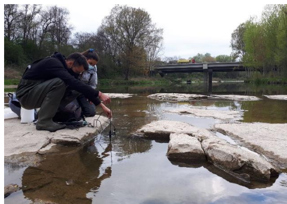
Figura 5. Sondes de conductivitat elèctrica, pH, temperatura i oxigen dissolt, per a la presa de dades in situ a cada punt de mostreig.
