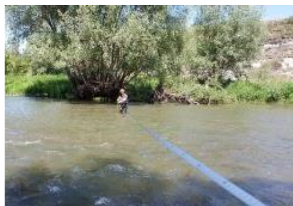
Figura 3. Mesura de la velocitat de l'aigua amb un correntòmetre de molinet –model FP101 de Global Water- i presa de dades de l'amplada i la profunditat, al riu Ter, per obtenir-ne el cabal.
