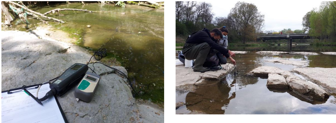
Figura 5. Sondes de conductivitat elèctrica, pH, temperatura i oxigen dissolt, per a la presa de dades in situ a cada punt de mostreig.
