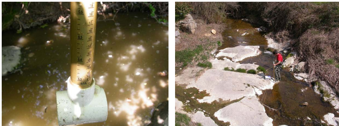
Figura 3: Correntòmetre de molinet –model FP101 de Global Water- emprat per mesurar la velocitat de l'aigua ( a l'esquerra). Mètode de mesura del cabal fent un transecte velocitat-àrea (a la dreta).
