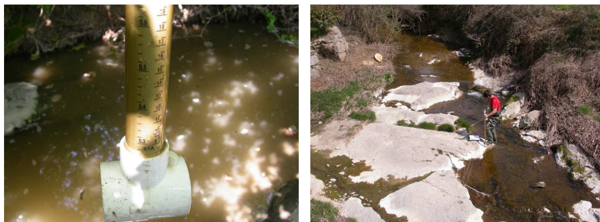
Figura 3: Correntòmetre de molinet –model FP101 de Global Water- emprat per mesurar la velocitat de l'aigua ( a l'esquerra). Mètode de mesura del cabal fent un transecte per aplicar el mètode velocitat-àrea (a la dreta).
