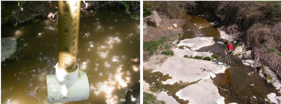
Figura 3. Correntímetre de molinet –model FP101 de Global Water- emprat per mesurar la velocitat de l'aigua ( a l'esquerra) i mesura del cabal pel mètode velocitat-àrea (a la dreta).
