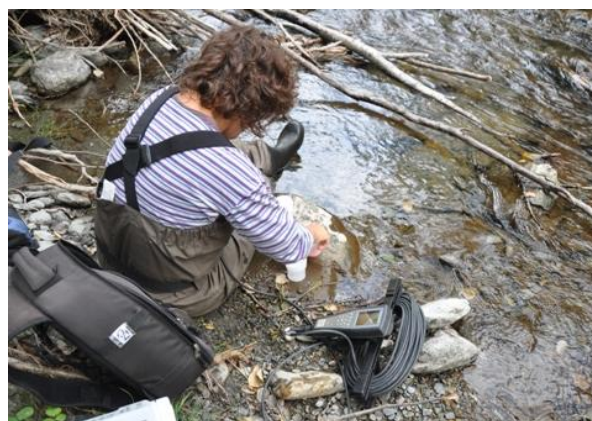
Figura 4. Presa de dades fisicoquímiques mitjançant la sonda multi paramètrica portàtil YSI Professional Plus
