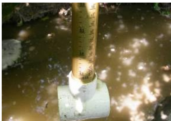
Figura 3. Correntòmetre de molinet –model FP101 de Global Water- emprat per mesurar la velocitat de l'aigua
