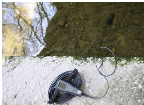
Figura 4. Sonda multi paramètrica portàtil YSI Professional Plus per prendre les mesures fisicoquímiques in-situ
