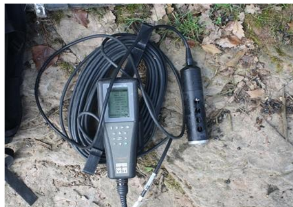
Figura 4. Sonda multi paramètrica portàtil YSI Professional Plus per prendre les mesures fisicoquímiques in-situ
