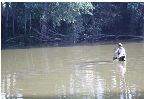
Figura 3. Mesura de la velocitat de l'aigua amb un correntòmetre de molinet –model FP101 de Global Water-, l'amplada i la profunditat del riu per obtenir el cabal
