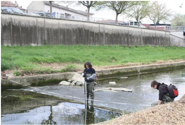
Figura 3. Mesura de la velocitat de l'aigua amb un correntòmetre de molinet –model FP101 de Global Water-, l'amplada i la profunditat del riu per obtenir el cabal
