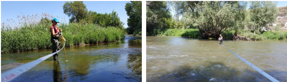
Figura 3. Mesura de la velocitat de l'aigua amb un correntòmetre de molinet –model FP101 de Global Water-, l'amplada i la profunditat del riu per obtenir el cabal.
