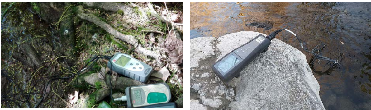
Figura 4. Sondes de conductivitat elèctrica, pH, temperatura i oxigen dissolt –imatge de l'esquerra-. l'oxigen dissolt a l'aigua (en % de saturació i en mg/L) i l'oxigen i la temperatura amb la Sonda d'oxigen YSI Pro 20 –imatge de la dreta-.
