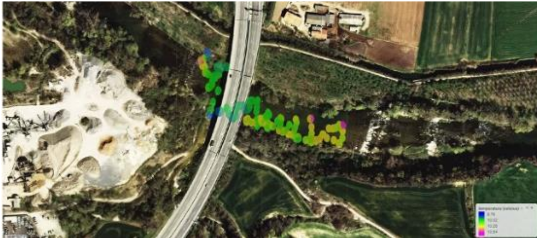
Figura 47. Ortofotomatge de la desembocadura del Sorreigs al riu Ter (Te16) amb la temperatura de l'aigua (°C) obtinguda amb el vaixell INTCATCH (5 de març de 2019).
