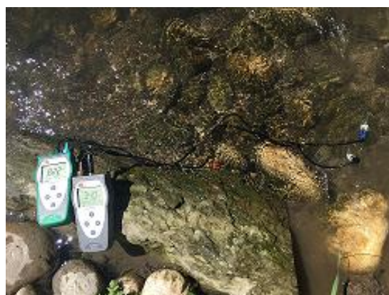
Figura 4. Sondes de conductivitat elèctrica, pH, temperatura i oxigen dissolt. Mesures preses in situ cada dia de mostreig.
