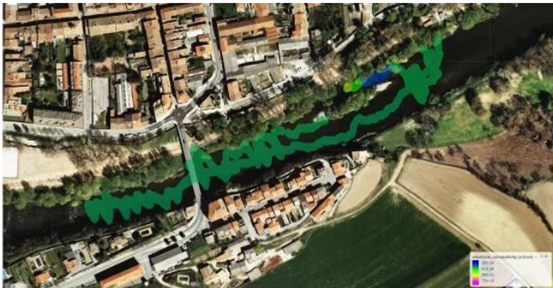
Figura 49. Ortofotomatge del passeig del Ter de Manlleu amb la concentració de conductivitat elèctrica ( \mu\text{S}/\text{cm} ) obtinguda amb el vaixell INTCATCH (19/09/19)
