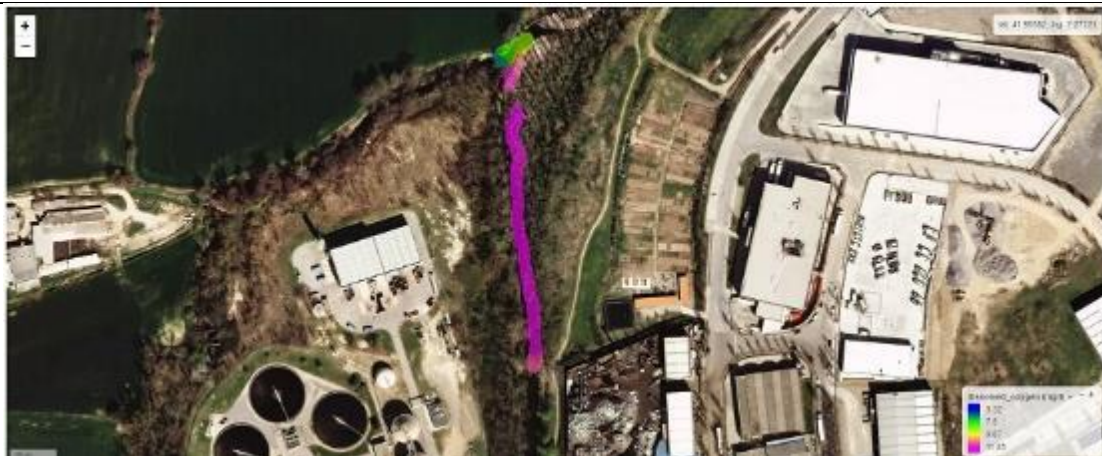
Figura 51. Ortofotomatge de la desembocadura del Rimentol al riu Gurri amb la concentració d'oxigen dissolt a l'aigua ( \text{mg}/\text{L} ) obtinguda amb el vaixell INTCATCH (24/04/19)
