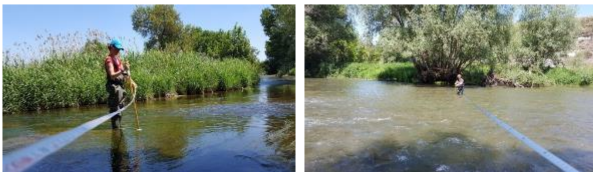
Figura 3. Mesura de la velocitat de l'aigua amb un correntímetre de molinet –model FP101 de Global Water-, l'amplada i la profunditat del riu per obtenir el cabal.
