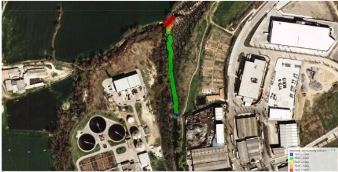
Figura 50. Ortofotomatge de la desembocadura del Rimentol al riu Gurri amb la concentració de conductivitat elèctrica ( \mu\text{S}/\text{cm} ) obtinguda amb el vaixell INTCATCH (24/04/19)
