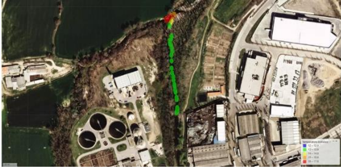
Figura 52. Ortofotomatge de la desembocadura del Rimentol al riu Gurri amb la temperatura de l'aigua (°C) obtinguda amb el vaixell INTCATCH (24/04/19)
