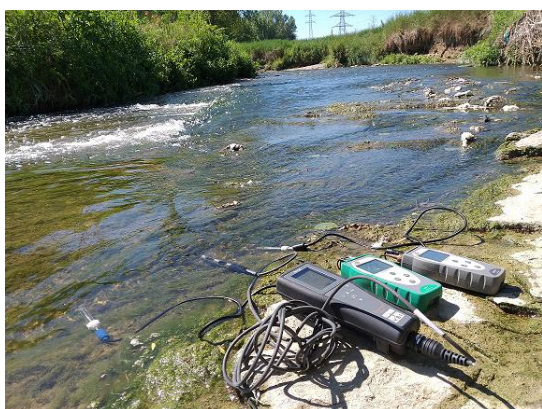
Figura 4. Sondes de conductivitat elèctrica, pH, temperatura i oxigen dissolt. Mesures preses in situ cada dia de mostreig.
