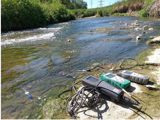
Figura 5. Sonde de conductivitat elèctrica, pH, temperatura i oxigen dissolt, per a la presa de dades in situ cada dia de mostreig.
