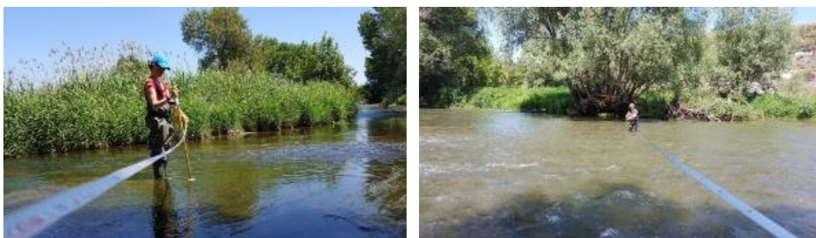
Figura 3. Mesura de la velocitat de l'aigua amb un correntòmetre de molinet –model FP101 de Global Water- i presa de dades de l'amplada i la profunditat, al riu Ter, per obtenir-ne el cabal.
