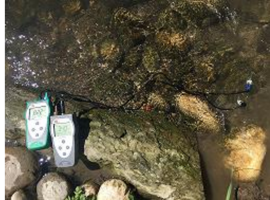
Figura 5. Sonde de conductivitat elèctrica, pH, temperatura i oxigen dissolt, per a la presa de dades in situ cada dia de mostreig.
