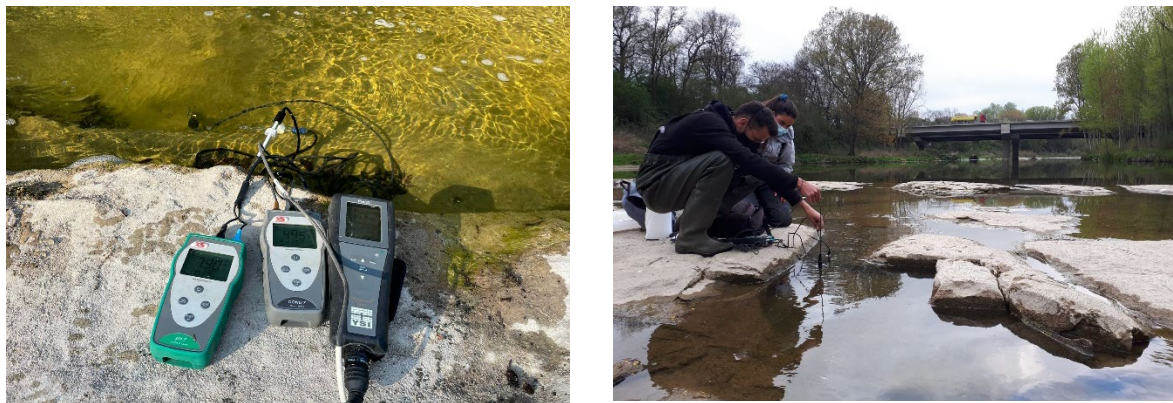
Figura 5. Sondes de conductivitat elèctrica, pH, temperatura i oxigen dissolt, per a la presa de dades in situ a cada punt de mostreig.
