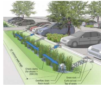
Sistema cuneta verda
