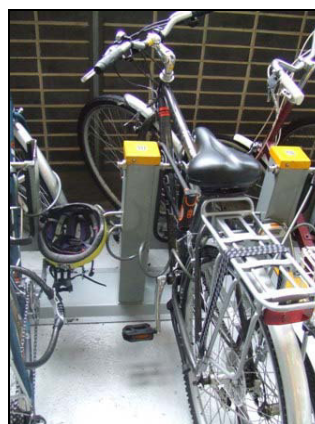
Figura 25: Soportes con antirrobo incorporado en una biciestación de Londres (BACC)
