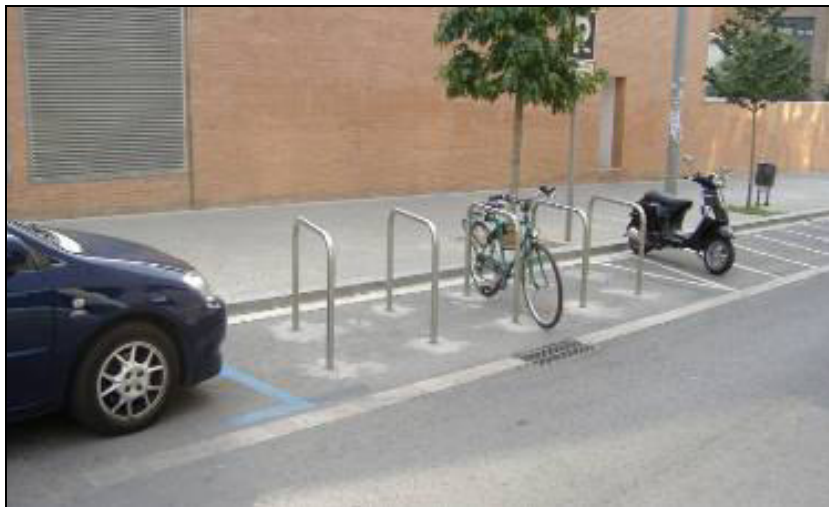
Figura 45: Aparcabis en calzada, ocupando una antigua plaza de coche (BACC)
