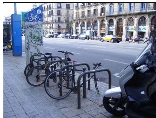
Figura 80: Aparcabicis con bolardos contra la invasión de motos (BACC)
