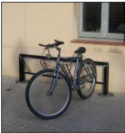
Figura 13: Aparcabicis con soportes de rueda verticales (Marcus Willcocks)
