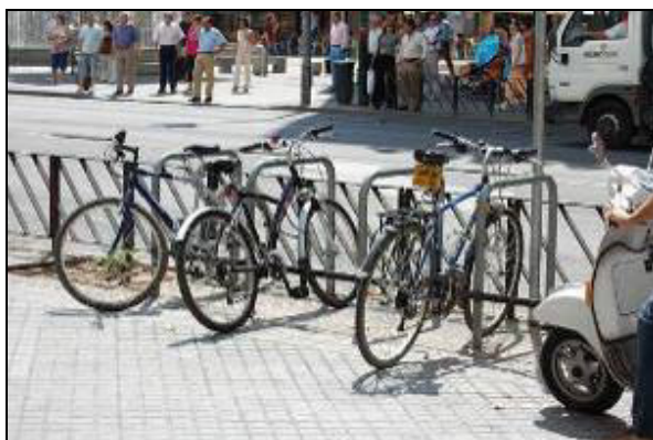
Figura 79: Aparcabicis con una barra contra la invasión de motos (Juanma Zurita)
