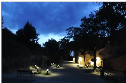
Fotografia 11. Vial d'entrada a Riner (Solsonès) amb enllumenat amb pilones que guien el vial enllloc d'il·luminar l'espai.
